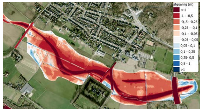
Figuur 25. Afgraving Groene Rivier ten opzichte van AHN3, combinatie van bodemvolgend t.p.v. historische restgeulen en elders beperkt maaiveldvolgend; bron: RHDHV
