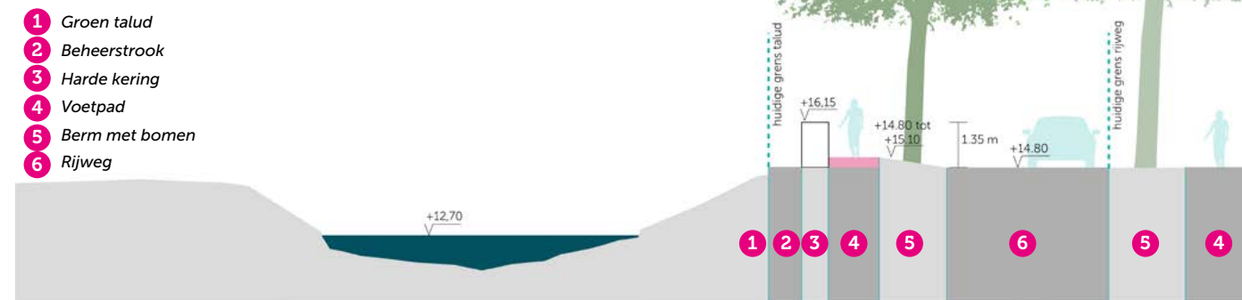
Figuur 81. Principeprofiel constructieve kering in de Kasteellaan.
