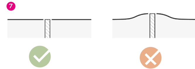
Figuur 94. Principe: Coupure op gelijke hoogte als wegdek.
