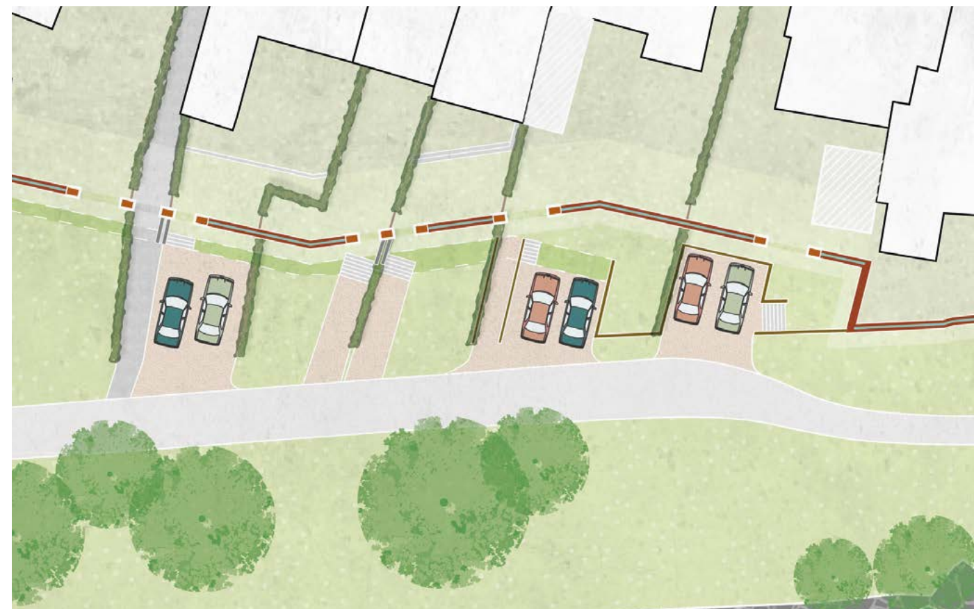
Figuur 112. Deeluitwerking inpassing kering achtertuinen langs de Grotestraat tussen nr. 13 en nr. 17.
