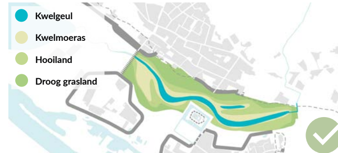
Figuur 28. Schematische impressie van bodemvolgend ontgraven t.p.v. restgeulen (= gedeeltelijk uitgraven), de overige ontgraving maaiveldvolgend.
