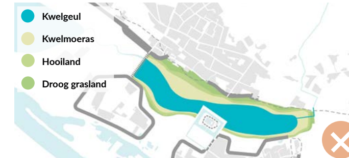
Figuur 30. Schematische impressie van inrichtingsbeeld bij het bodemvolgend afgraven van de Groene Rivier (= afgraven tot aan het zand). Het gevolg is grote plas water.
