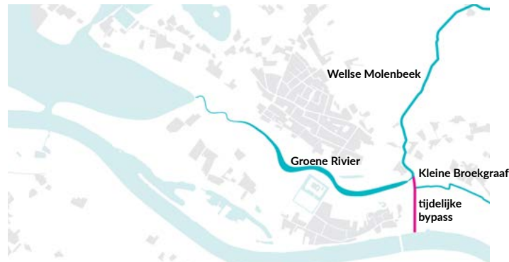
Figuur 58. Schema: Watersysteem, tijdelijke bypass ten behoeve van de waterkwaliteit.
