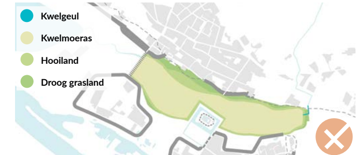
Figuur 32. Schematische impressie van inrichtingsbeeld bij het maaiveldvolgend afgraven van de Groene Rivier. Het gevolg is een groot kwelmoeras en ontbreken van open water.
