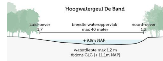
Figuur 51. Principeprofiel: Onderscheid tussen een steile noordoever en een flauw talud voor de zuidoever.
