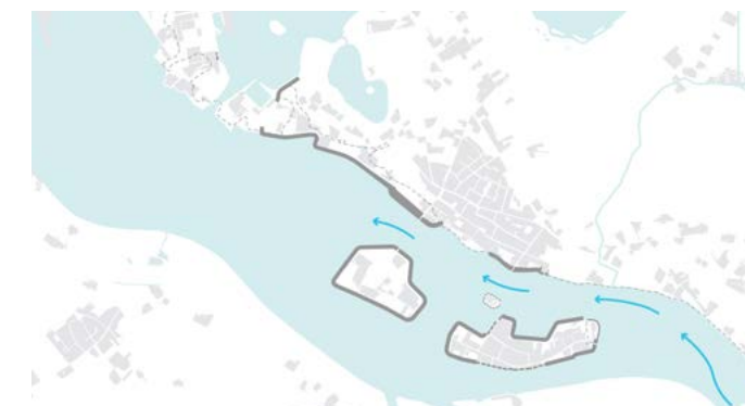
Figuur 17. Schema: Inschatting inundatie bij hoogwater 1x per 20 jaar: ook de akkers staan onder water, het water staat tot aan de dijk.
