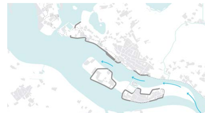
Figuur 16. Schema: Inschatting inundatie bij hoogwater 1x per 2 a 3 jaar: daarbij staan de lage delen van de Groene Rivier onder water, maar de akkers blijven nog droog.
