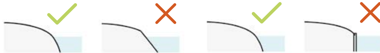
Figuur 61. Principe oever kasteelwal: een glooiende oever, geen recht talud.
