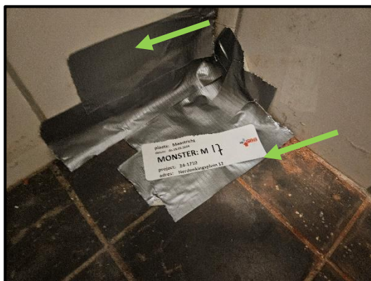
M17 – tegellijm en -voegsel vloeren en wanden sanitair ruimtes bouwdeel A
