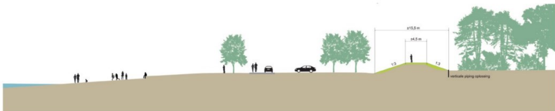
Figuur 3-3 Dwarsdoorsnede van dijkprofiel van het voorkeursalternatief ter hoogte van de Grote Hegge
