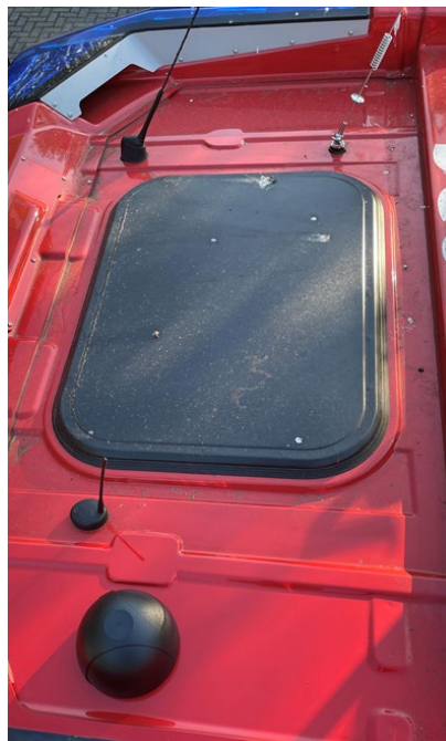
Voorbeeld dak opstelling antennes
