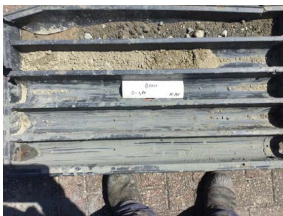
F010: B001C, Boorlaag 0,00-1,80 m-mv
