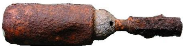
Mortiergranaat 2inch (Ø 50,8mm)
