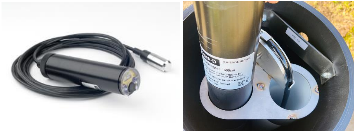
Figuur 14: Foto's van druksensor en datalogger (links) en datalogger met kabel in peilbuis (rechts)
