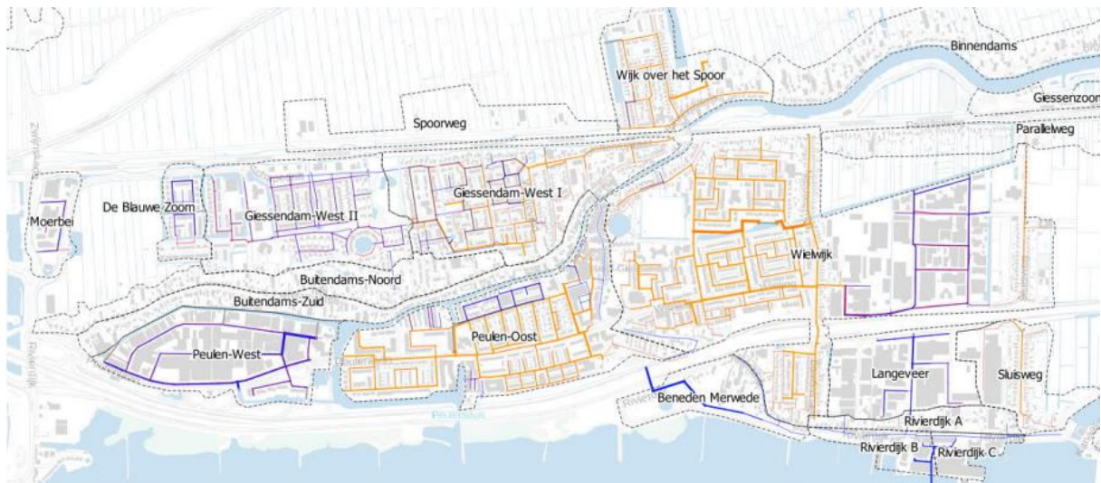
Figuur 5.1 Vrijverval riolering Hardinxveld-Giessendam en Blauwe Zoom (Bron: Sweco, 11 maart 2022)
