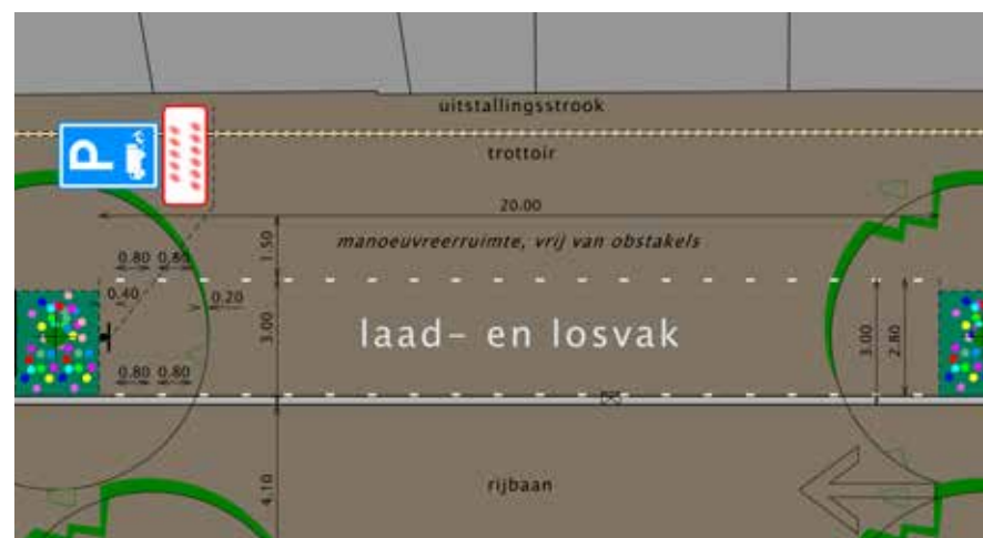
Afb. 2.32 Principe detail van een laad- en losvak
