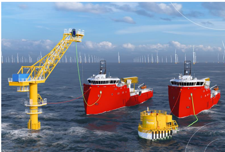
Afbeelding 4.1 Visualisatie van een e-tower concept en een laadboei concept (bron: Bluewater)
