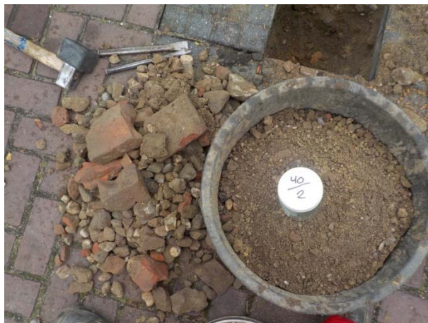
Foto 10. Fijne en grove fractie proefgat 40
