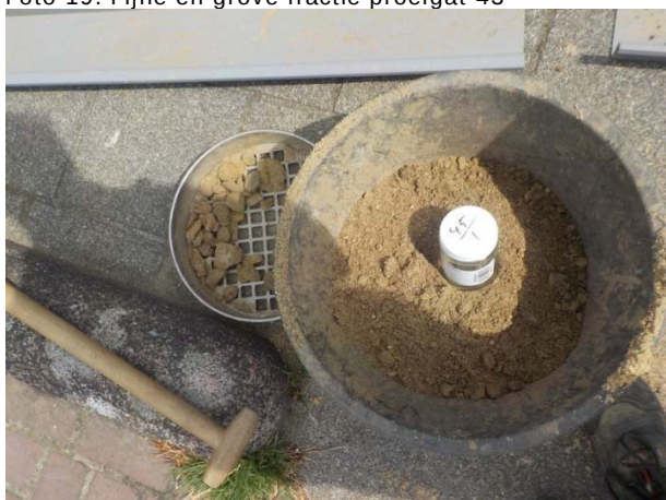
Foto 21. Fijne en grove fractie proefgat 45
