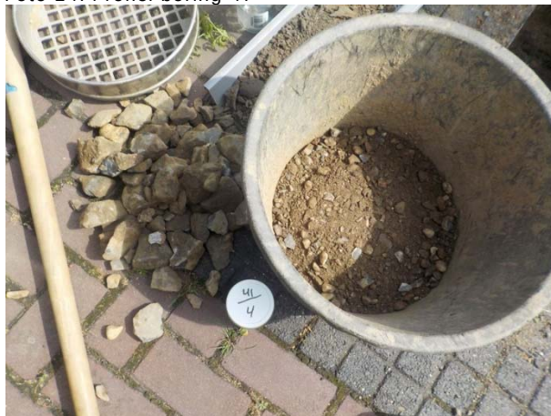
Foto 16. Fijne en grove fractie proefgat 41
