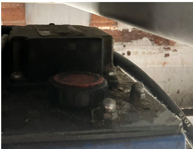
Figuur 3, afbeelding van een vuldop met beluchtingsfilter met vuil aanwezig op het deksel (eigen foto)
