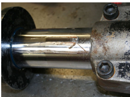
Figuur 9, voorbeeld van een beschadigde plunjer van een hydrauliek cilinder (bron: www.held-hydraulik.de )
