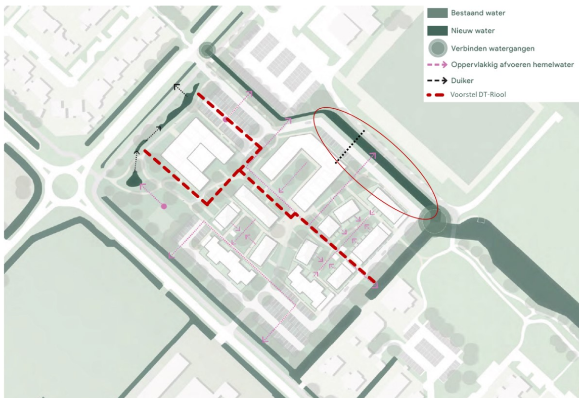
Afbeelding 5.1 Watersysteem en mogelijke inrichting van gebiedsontwikkeling op het Argon-terrein. Bestaande watergangen en opties voor nieuwe watergangen (donker en rood omcirkeld), Infiltratie-Transport-riool (IT-riool) weergegeven en locatie van profiel aangegeven (zwart gestippeld)
