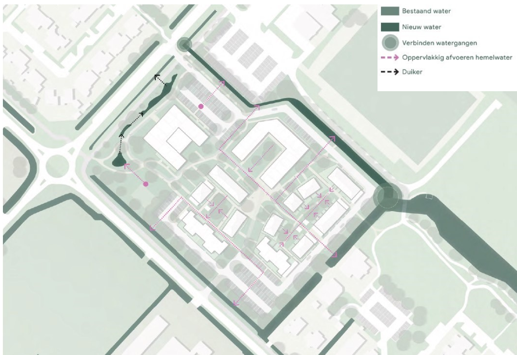
Afbeelding 4.1 Watersysteem en mogelijke inrichting van gebiedsontwikkeling op het Argon-terrein uit het ruimtelijk kader (Gemeente De Ronde Venen, 2023). Bestaande watergangen en opties voor nieuwe watergangen (donker) weergegeven
