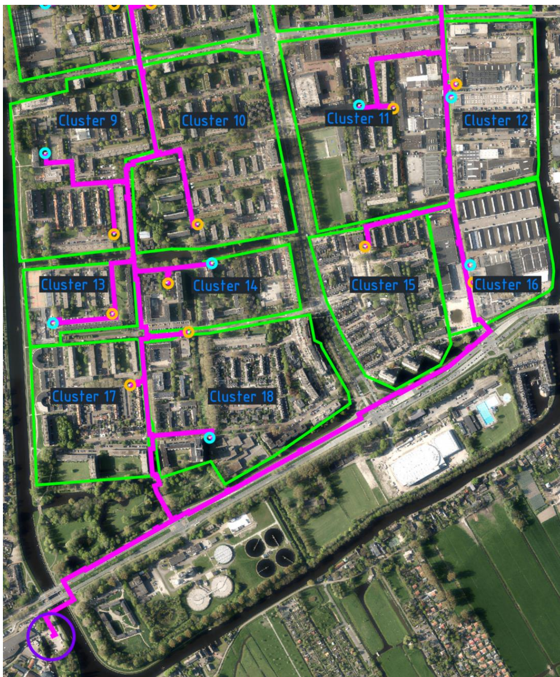
Figuur 3 Conceptontwerp van het hoofdtransportnet voor Leiden Zuidwest. De globale indeling van de clusters is aangegeven met een lichtgroene marking. Het conceptontwerp van het primaire warmtenet is weergegeven in roze. De oranje cirkels zijn indicatieve WOS-locaties, en de lichtblauwe cirkels zijn indicatieve IWAS-locaties, ten behoeve van het schetsontwerp van het primaire net. In het verfijnde ontwerp van het secundaire net (niet weergegeven in dit figuur) zullen meerdere WOS- en IWAS-locaties per cluster worden opgenomen (indien relevant). De locatie van de warmtebron is aangegeven met de paarse cirkel, linksonderin. Dit figuur toont het zuidelijke deel van het gebied; het noordelijke deel is weergegeven in Figuur 2.
