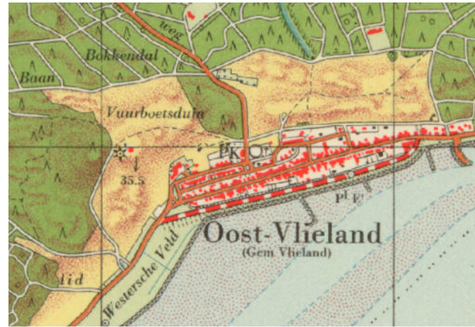
1963: Waddenzeedijk aan de westzijde verlegd, rechtdoor getrokken richting Postweg
