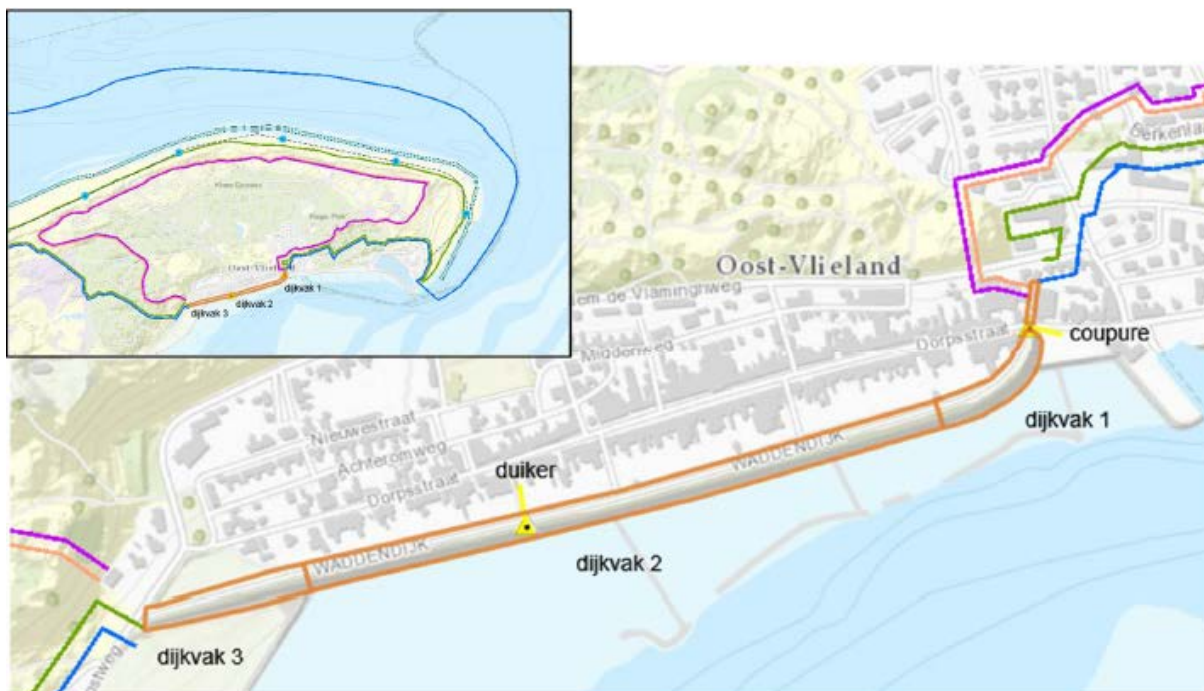
Figuur 3.1 In bruin de locatie van de dijkversterking met de dijkvakken (de roze, groene en blauwe lijnen zijn de zgn. zandige kering. Dit zijn de duinen die in de legger als primaire kering zijn opgenomen. Gezamenlijk met de waddenzeedijk vormt dit de dijkkring)
