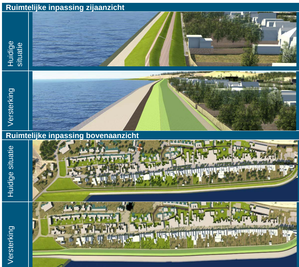
Figuur 3.6. Impressie van de inpassing van de dijkversterking in de omgeving
