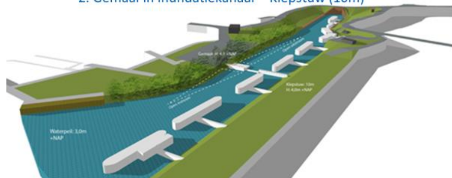
2. Gemaal in inundatiekanaal – Klepstuw (10m)
