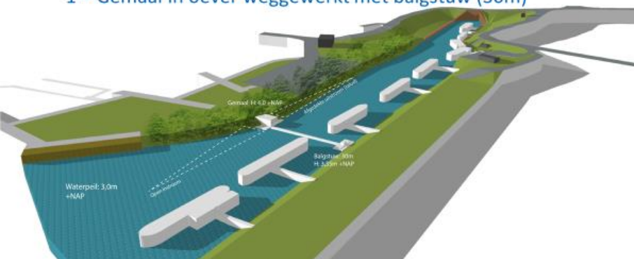
1 – Gemaal in oever weggewerkt met balgstuw (30m)
