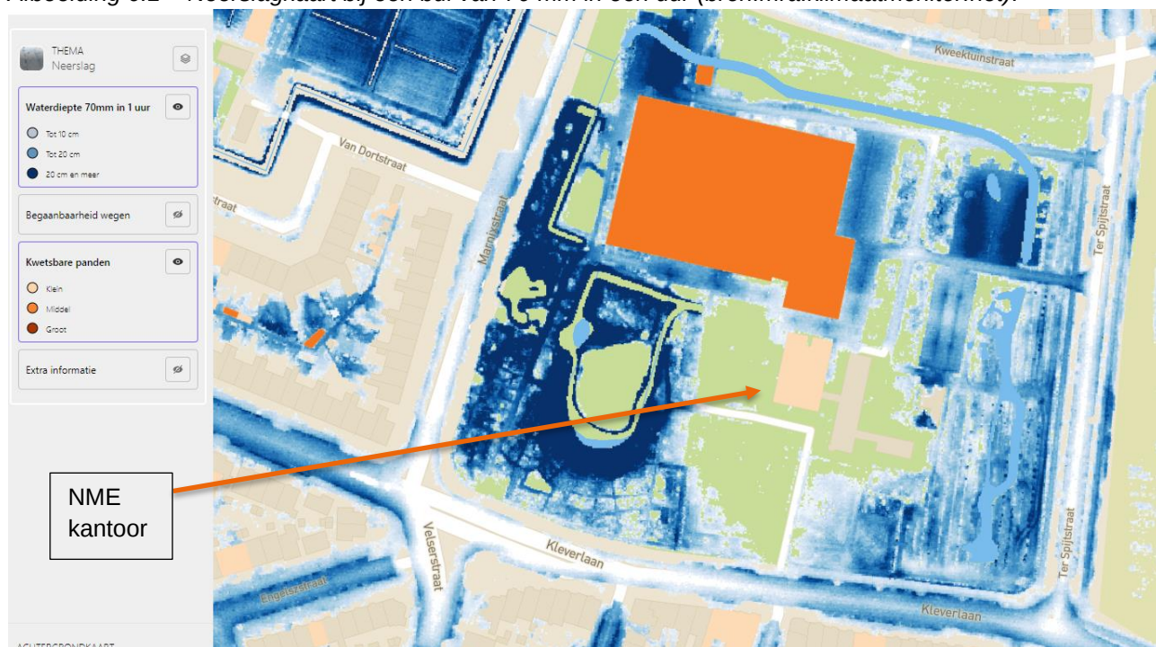
Afbeelding 6.1 – Neerslagkaart bij een bui van 70 mm in één uur (bron: mra.klimaatmonitor.net ).
