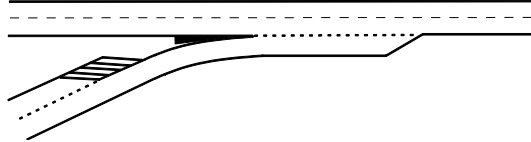
afbeelding 4.13 Principeschets invoeging met tweestrooks toeleidende rijbaan
