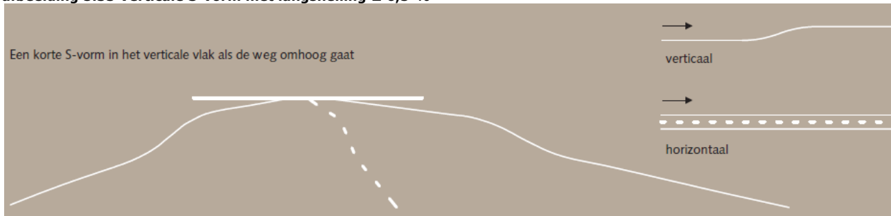
afbeelding 5.33 Verticale S-vorm met langshelling \geq 0,5 %
