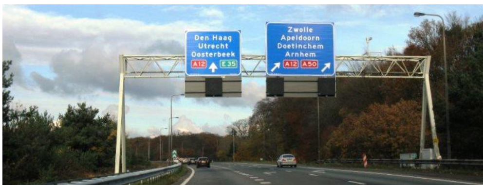
Figuur 5 Voorbeeld: route A50 loopt gedeeltelijk over wegnummer A12. Maar op de hectometerborden staat steeds het wegnummer aangegeven, niet een routenummer.
