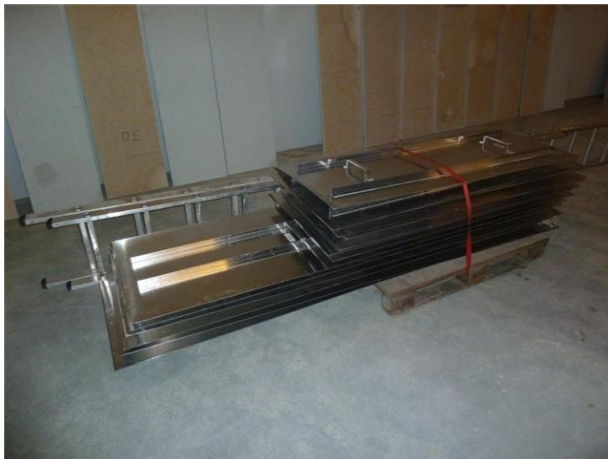
Foto 27: Aluminium afsluitplaten RWA-installatie
