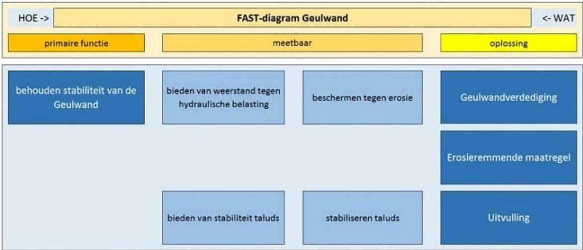
Figuur 2-5 FAST-diagram systeem Geulwand Ossenisse II
