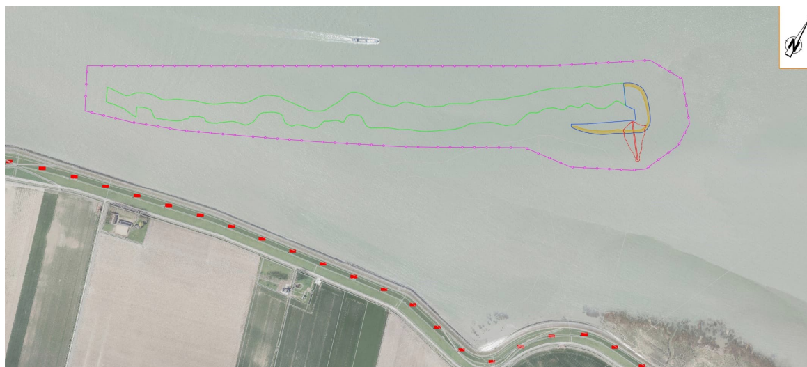
Figuur 2-4 Systeemgrenzen van Geulwand Ossensisse II, met onderverdeling in Werkvak, Stortvakken en het object Erosieremmende maatregel
