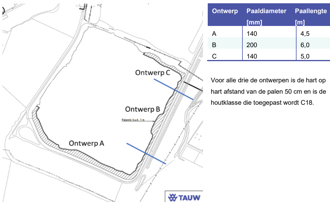
Figuur 3.1 Ontwerpen paalbeschoeiing binnen constructie
