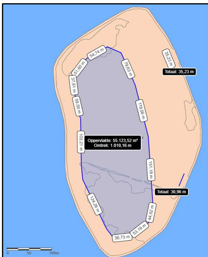
Figuur 1.3. Werktekening proefeiland Ierst. Oranje gebied ligt binnen de stenen ring. Blauwe lijnen zijn de rijshouten dammen. De donkerblauwe zone geeft de beoogde ondiepe zone weer. Bron: Rijkswaterstaat, 2024.
