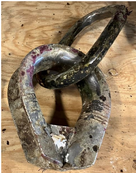
Figuur 6. Eindkoppeling RVS; kous met losse schalm
