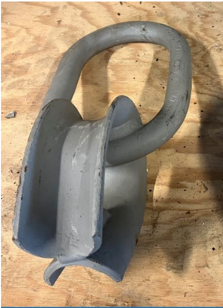
Figuur 7. Eindkoppeling staal; kous met aangelaste schalm.
