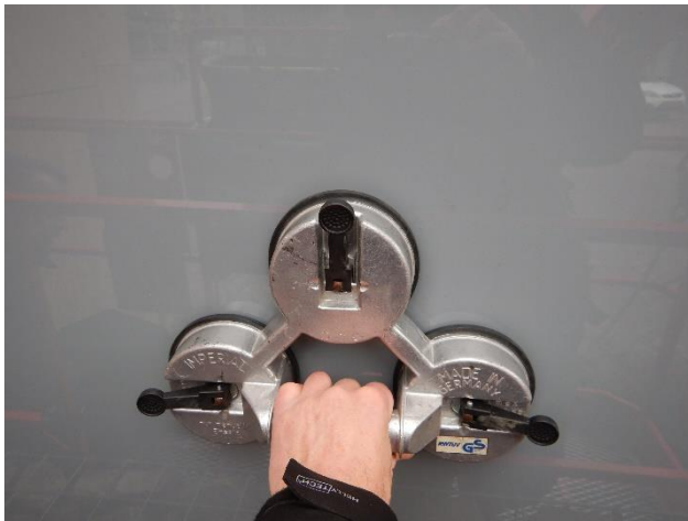
Foto 7 De bevestiging van de glaspanelen is gecontroleerd door uitvoering van indicatieve trekproeven.
