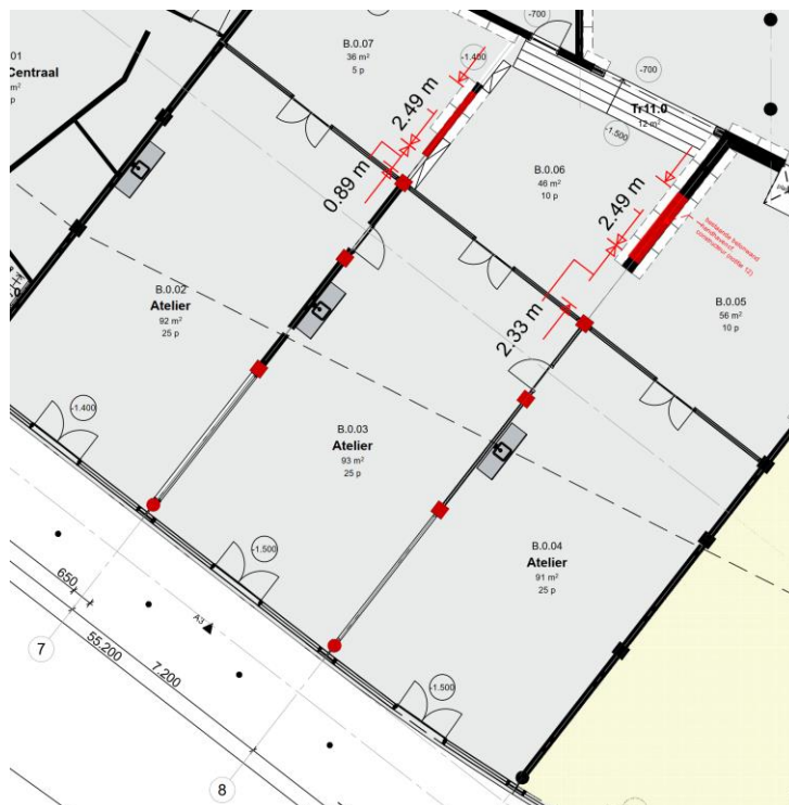
Afbeelding 6.10: positie betonconstructie volgens archiefstukken
