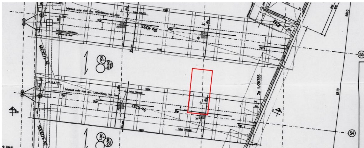
Afbeelding 9.6: fragment bovenwapening 2 e verdiepingvloer (archief)
