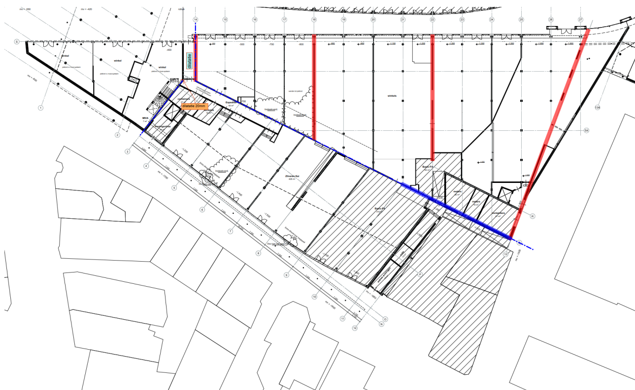
Afbeelding 6.1: stabiliteitswanden volgens oorspronkelijk ontwerp
