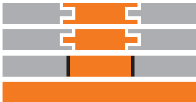
Figuur 11: Gesloten, volledige belemmering voor het (tussentijds) uittrekken van producten of elementen.
