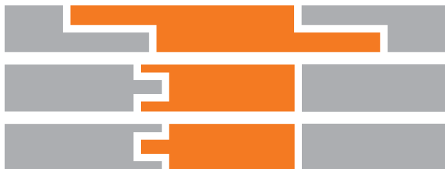
Figuur 10: Overlapping, gedeeltelijke belemmering voor het (tussentijds) uittrekken van producten of elementen.
