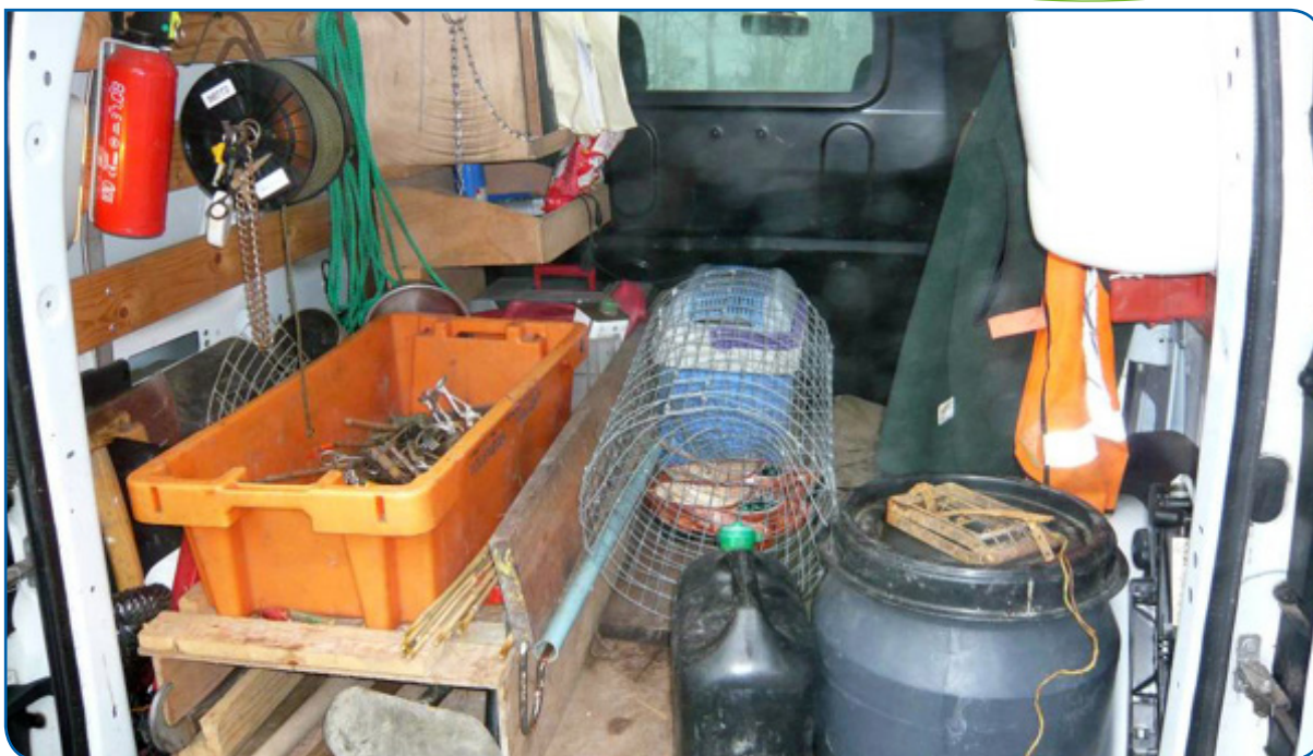
FOTO 3-4 GESCEIDEN SCHOON EN VUIL GEDEELTE. HET SCHONE GEDEELTE IS DE BESTUURDERSRUIMTE. HET VUILE GEDEELTE IS DE GEHELE LAADRUIMTE. DE RUIMTEN WORDEN GESCEIDEN DOOR DE WAND. RECHTSVOOR IS DE KADAVERTON WEERGEGEVEN.
