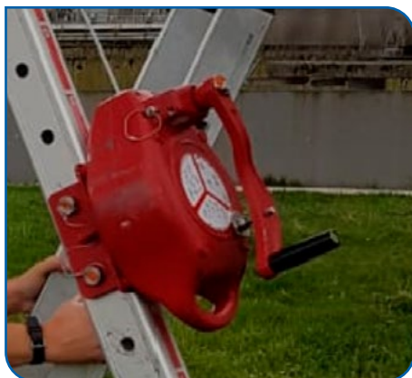
FIGUUR 2-27 VALBLOK MET GEÏNTEGREERDE VALDEMPER EN REDDINGSLIERFUNCTIE
