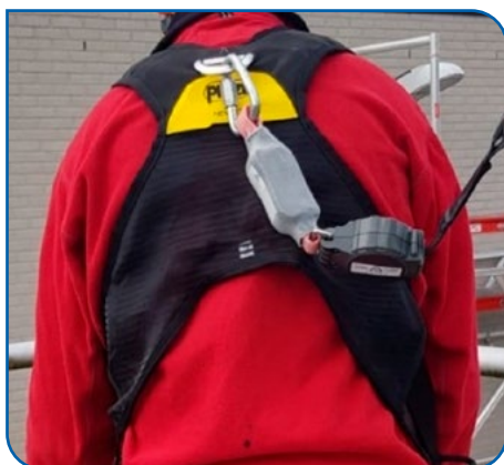
FIGUUR 2-25 VALBESCHERMINGSHARNAS EN VALBLOK MET EXTERNE VALDEMPER
