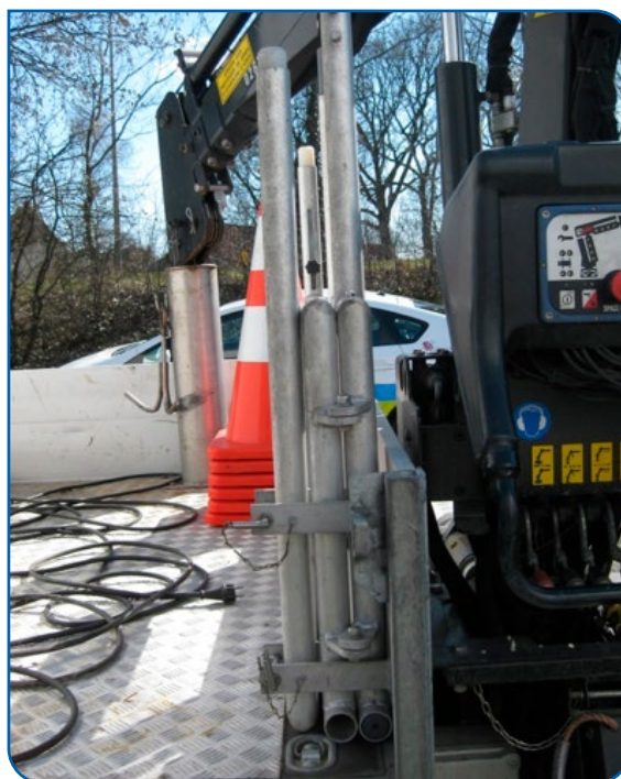
FIGUUR 2-10 MOBIEL HEKWERK: GEREED OM BEVESTIGD TE WORDEN
