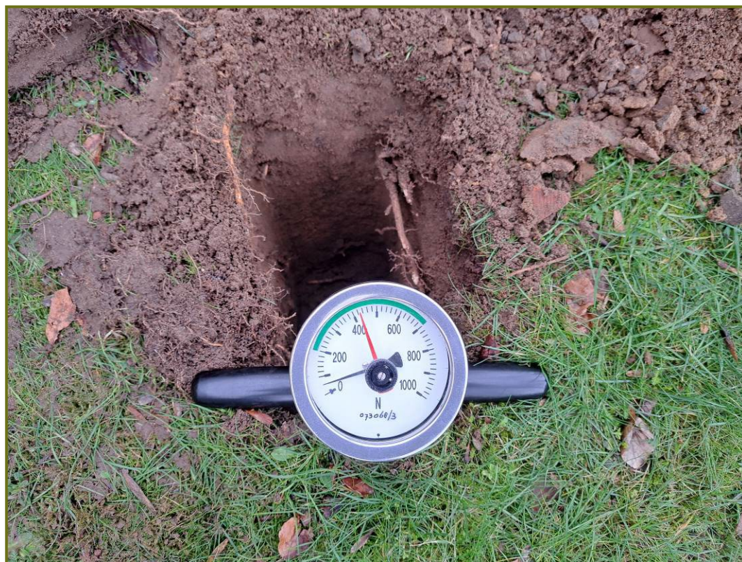
Afbeelding 11. Bodem is verhoogd verdicht vanaf 40-45 cm beneden maaiveld
