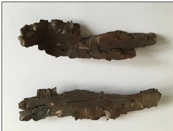
Afbeelding 27: Scherven na detonatie van een met springstof gevuld OO.
