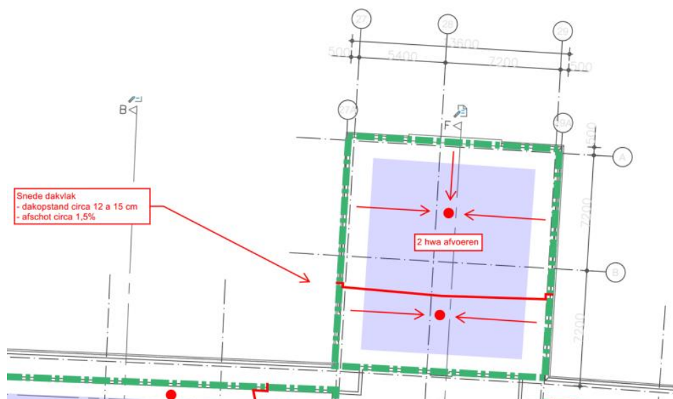
Figuur 2 Dakopstand en -afschot ter plaatse van de vleugels
