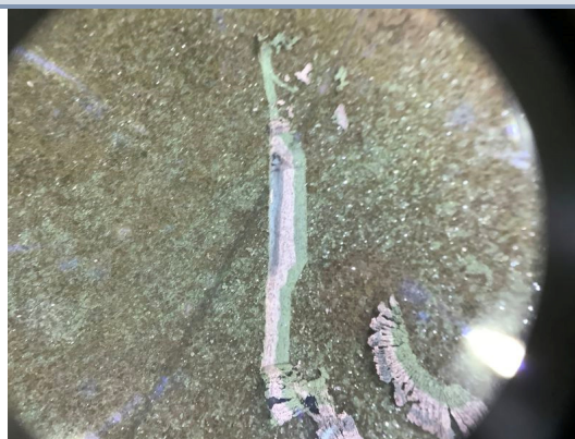
Opbouw verflagen Aantal verflagen: 5 Variant: Groen
