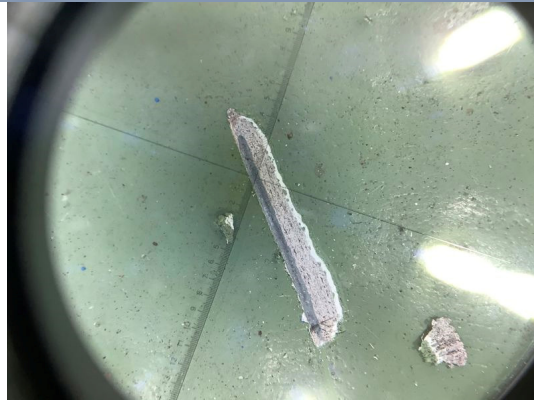
Opbouw verflagen Aantal verflagen: 6 Variant: Groen
