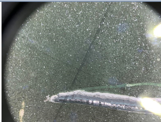
Opbouw verflagen Aantal verflagen: 5 Variant: Groen
