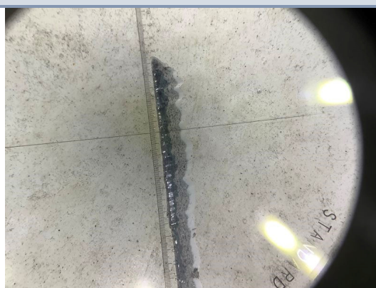
Opbouw verflagen Aantal verflagen: 3 Variant: Wit
