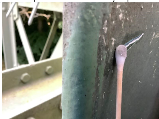
Resultaat in-situsneltest chroom-6: Geen chroom-6 aangetroffen
