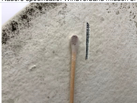
Resultaat in-situsneltest chroom-6: Geen chroom-6 aangetroffen
