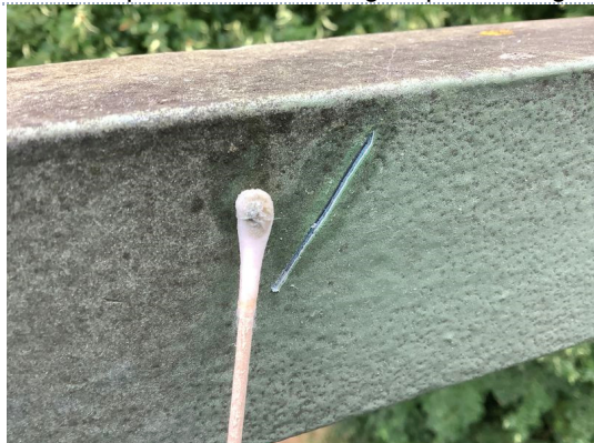
Resultaat in-situsneltest chroom-6: Geen chroom-6 aangetroffen
