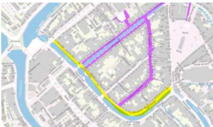
Figuur 4: in geel de Lage Gouwe waar parkeren wordt opgegeven en een gewichtsbepierking nodig is om de belasting van de kademuur te verminderen (en daarmee het risico op instorten)
