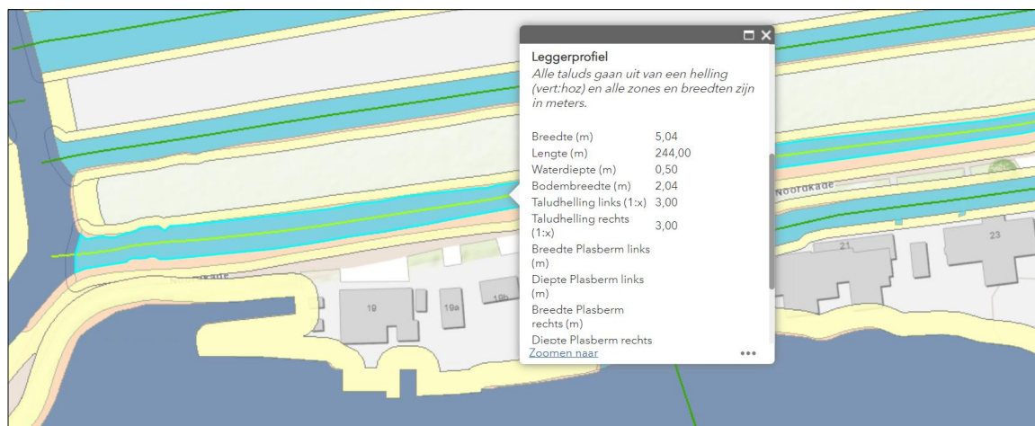
Figuur 3-2: Leggerprofiel teensloot binnenzijde Noordkade
