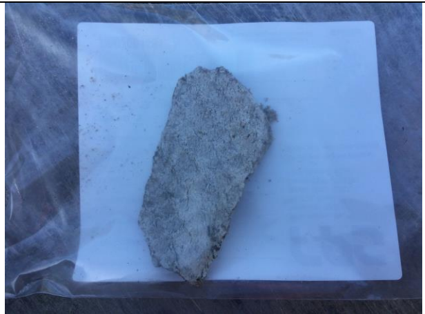
Foto 06 - asbestverdacht plaatmateriaal maaiveld
