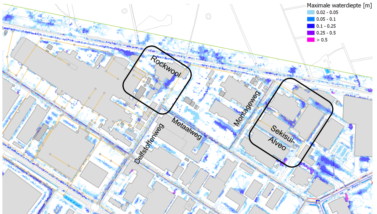
Figuur 34: Water op straat bij optreden bui C5 2014 in de huidige situatie.
