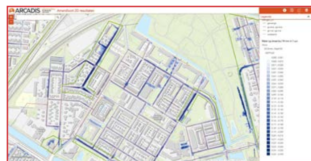
Rioleringsopgave in Arcadisviewer water op straat bij een piekbui van 74mm in 1 uur
