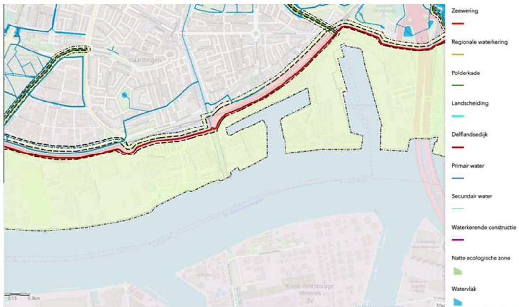
Figuur 5.37 Beschermingszone van het dijklichaam
