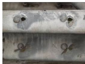
Afbeelding 9 Ernstige hak en slijpsporen
