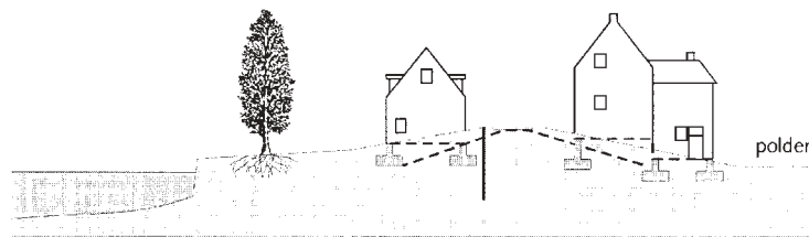
Figuur 8.2.2 Voorbeeld beoordelingsprofiel met erosiescherm
