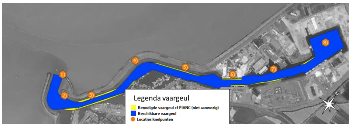
Afbeelding 3.2 Benodigde extra vaargeul breedte en locaties van nautische knelpunten
