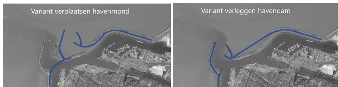
Afbeelding 4.2 Varianten binnen de oplossingsrichting 'compromis'
