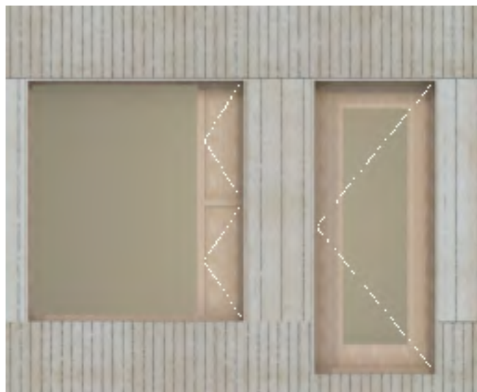
Speciale luiken in kozijnen opgenomen ten behoeve van spuien.
