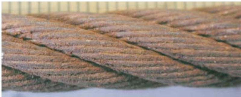
Classificatie : Klasse 2 (20%) Ruwe aantasting door corrosie, object zal rus aanvoelen.
