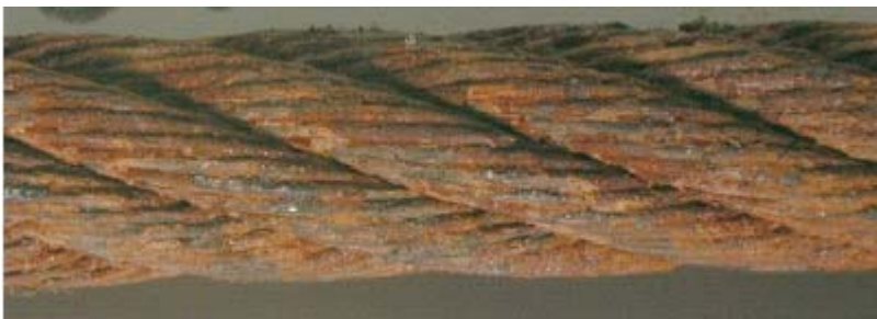
Classificatie : Klasse 2 (60%) Oppervlakte is zwaar aangetast door corrosie
