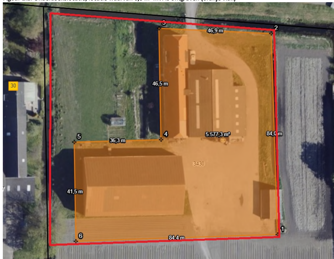
Figuur 2.2: Onderzoekslocatie, locatie waarvan 0,3 m -mv. is ontgraven (oranje vlak)
