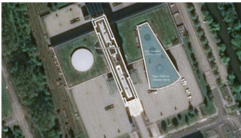
Foto 3.1: Overzicht beschikbare oppervlaktes PV op dak laagbouw Statenzaal
