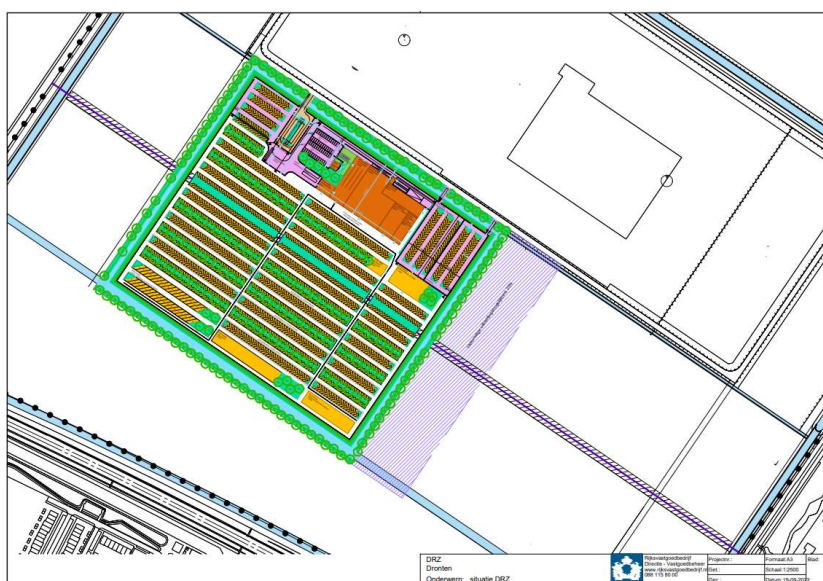
Figuur 1.3. Impressie ruimtelijke ontwikkeling (schetsontwerp met in het witte vlak overdekte buitenopslag en paars, oranje en geel komt binnenopslag en kantoren). Bron: Rijksvastgoedbedrijf, 2023.
