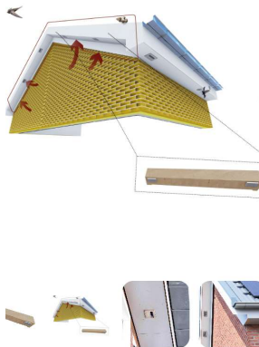
Figuur 2.20 vleermuisvoorziening (ook voor grotere vleermuissoorten) (unitura.nl)
