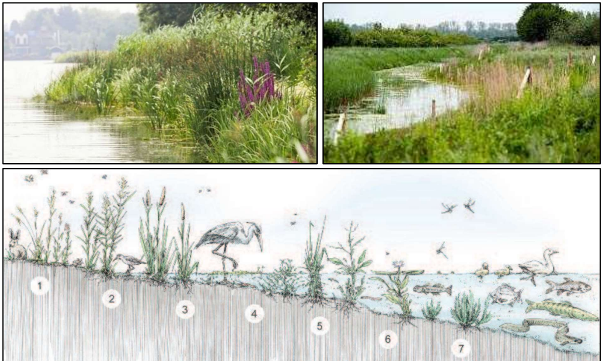
Figuur 2.35 Boven: voorbeelden van natuurvriendelijke oevers. Onder: Een schematische illustratie van een natuurvriendelijke oever met verschillende zones - 1: bloemrijk grasland, 2: vegetatie van vochthoudende grond, 3: vegetatie van natte ruigtes (plas-dras), 4: moerasplanten in ondiep water, 5: moerasplanten in dieper water, 6: drijfbladplanten, 7: ondergedoken waterplanten. Bron: Handreiking natuurvriendelijke oevers, STOWA, 2009.
