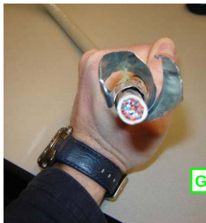
foto 15. Afgeschermd telecom stamkabel (10x4x0,5) die wordt toegepast bij ATM (zie ook bijlage B4.4.2) en wel geschikt is om als EMC afscherming te dienen.
